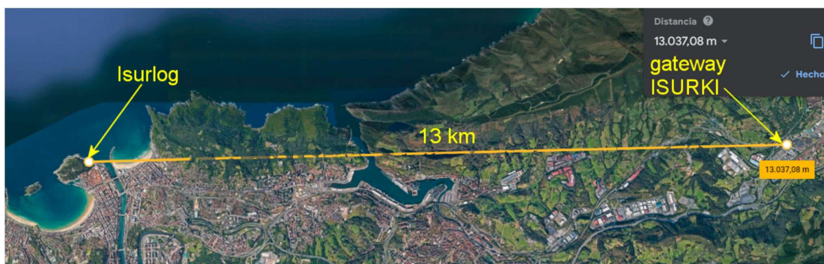
Enlace LoRa entre un nodo ISURLOG situado en el monte Urgull de San Sebastián y la sede de ISURKI en Irún.
